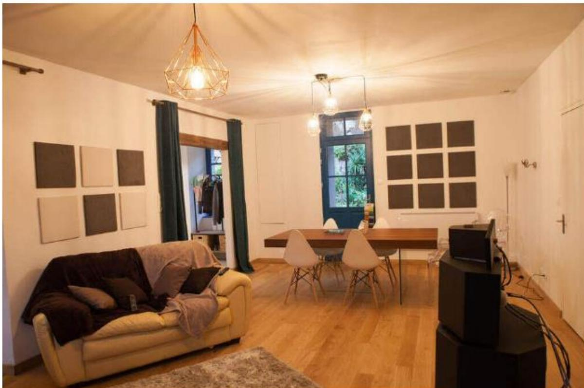
Ces panneaux diffusants utilisent toujours le principe du sandwich multidensités. Cette fois, avec la membrane en bois supplémentaire, quatre matériaux sont mis en œuvre avec les densités suivantes : 75 kg/m<sup>3</sup>, 450 kg/m<sup>3</sup>, 170 kg/m<sup>3</sup> et 40 kg/m<sup>3</sup>.
