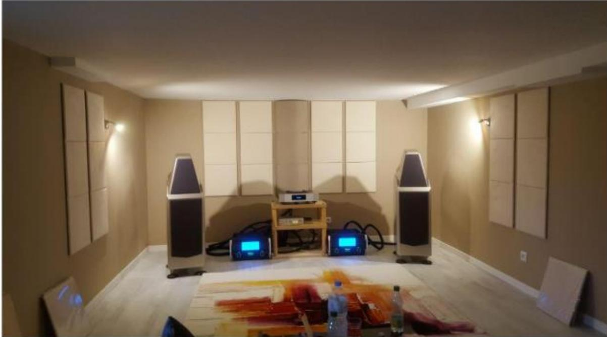
Sans trahir leur composition exacte, les panneaux PYT SMAD sont multicouches et multidensités. La porosité est absente contrairement à des panneaux en mousse. PYT Audio communique toutefois sur les densités des trois types de matériaux employés : 75 kg/m<sup>3</sup>, 170 kg/m<sup>3</sup> et 40 kg/m<sup>3</sup>. Une trame intégrée et une méthode de collage spécifique assurent une longue tenue dans le temps.
